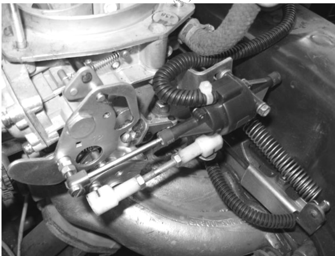
Рисунок 4.5. Крепление на карбюраторе Солекс.
