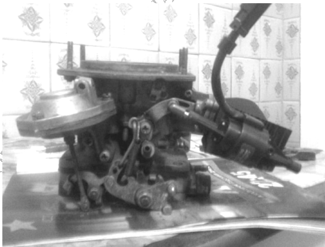
Рисунок 4.9. Кронштейн и моторедуктор на карбюраторе Озон.
