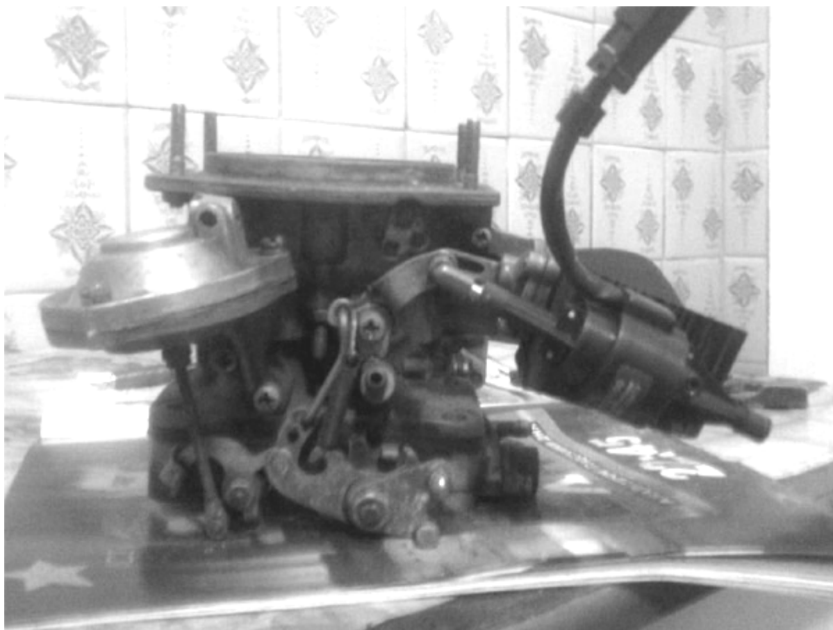
Рисунок 4.9. Кронштейн и моторедуктор на карбюраторе Озон.
