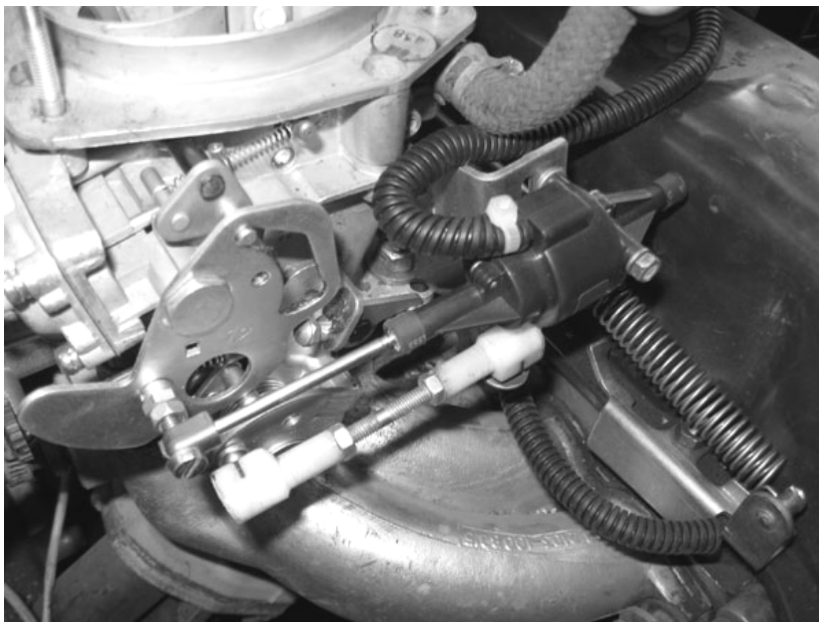
Рисунок 4.5. Крепление на карбюраторе Солекс.
